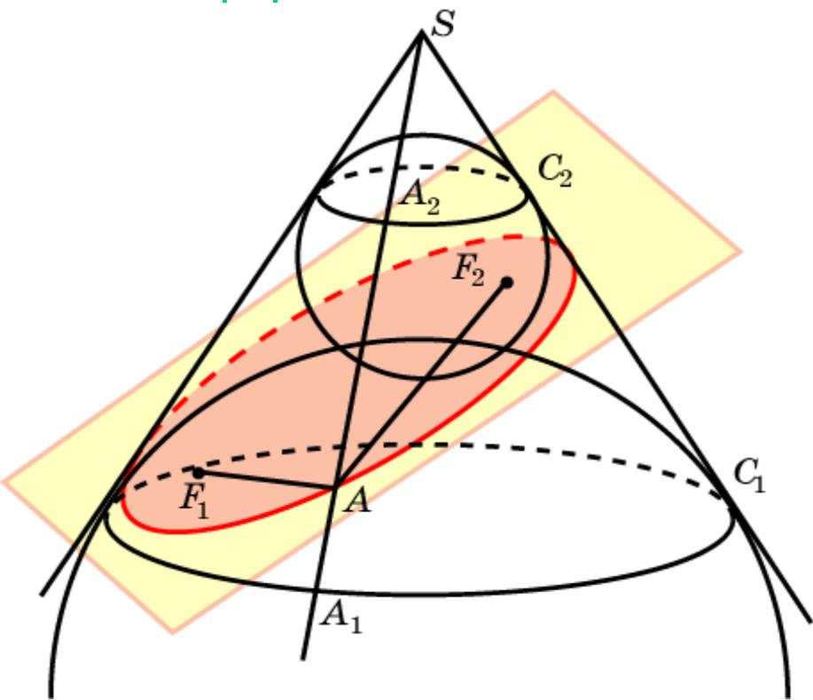
Воспользуемся тем, что отрезки касательных, проведенных к сфере из одной точки, равны. Тогда  $AF_1 = AA_1$ ,  $AF_2 = AA_2$ . Поэтому  $AF_1 + AF_2 = AA_1 + AA_2 = A_1A_2$ . Но длина отрезка  $A_1A_2$  не зависит от выбора точки  $A$  сечения. Она равна образующей соответствующего усеченного конуса. Поэтому сумма расстояний от точки  $A$  до точек  $F_1$ ,  $F_2$  будет постоянной.
