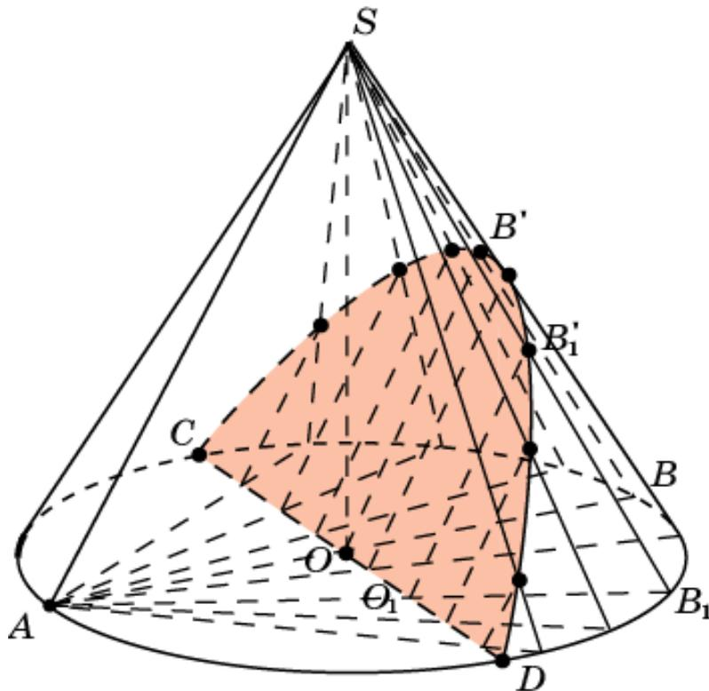
Через какую-нибудь точку  $O_1$  диаметра  $CD$  проведем прямую  $AO_1$  и ее точку пересечения с эллипсом основания обозначим  $B_1$ . Через точку  $O_1$  проведем прямую, параллельную  $SA$  и ее точку пересечения с  $SB_1$  обозначим  $B'_1$ . Она будет принадлежать искомому сечению. Аналогичным образом построим несколько других точек.
